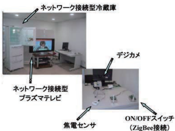
図2.10.11 ゆかりコアを用いた家電機器とセンサネットワークの接続実験
