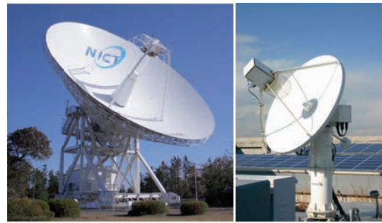
図2.16.10 VLBI用34mアンテナ(左)と超小型アンテナ(右)
