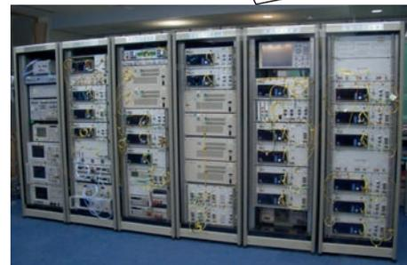
図2.1.12 進化し続ける光パケットスイッチプロトタイプ
