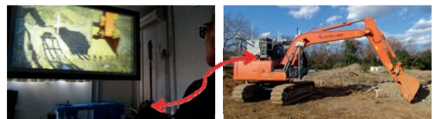
図2.9.32 高精細立体映像を用いた建設機械の遠隔操作実験
