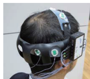
図2.11.14 ドライ電極を利用した小型モバイルワイヤレス脳波計
