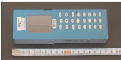
図2 ● 携帯端末外観（重量266g、容積264cc 電池含まず）
