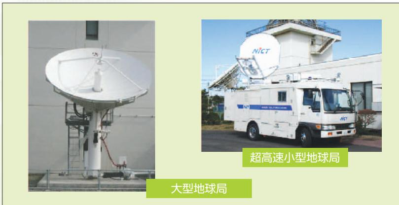
図4 ● 大型地球局と超高速小型地球局
