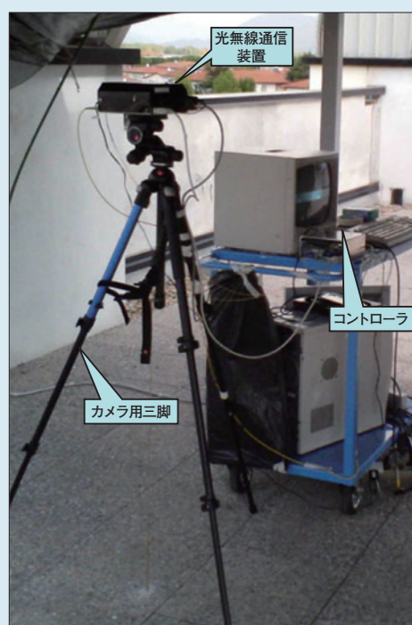
図5●サンタナ大学通信研究所の屋上に設置した光無線通信装置の外観(左)と、光無線通信装置から見た折り返し局(右)
