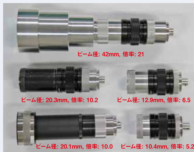
図3●試作した光アンテナ(倍率5.2倍から21倍まで、ビーム直径10mmから42mmまでの5種類)
