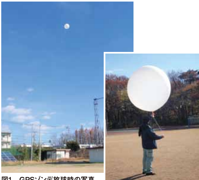
図1 GPSゾンデ放球時の写真 気球に観測装置を付けて放球(2012年12月)。
