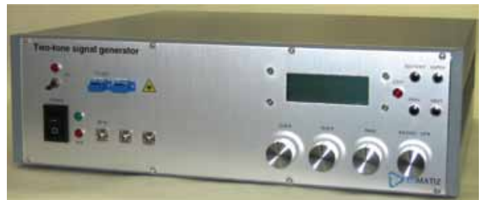
図4 光検出器周波数特性測定用基準光発生装置 (株式会社トリマティス提供)
