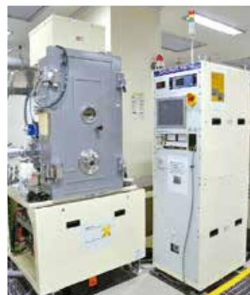
図3 電子ビーム蒸着装置
