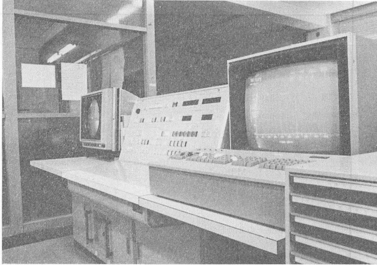
第18図 データ処理系の一部。左からモニター用PPI装置，監視制御装置及びカラーグラフィックディスプレイ装置。
