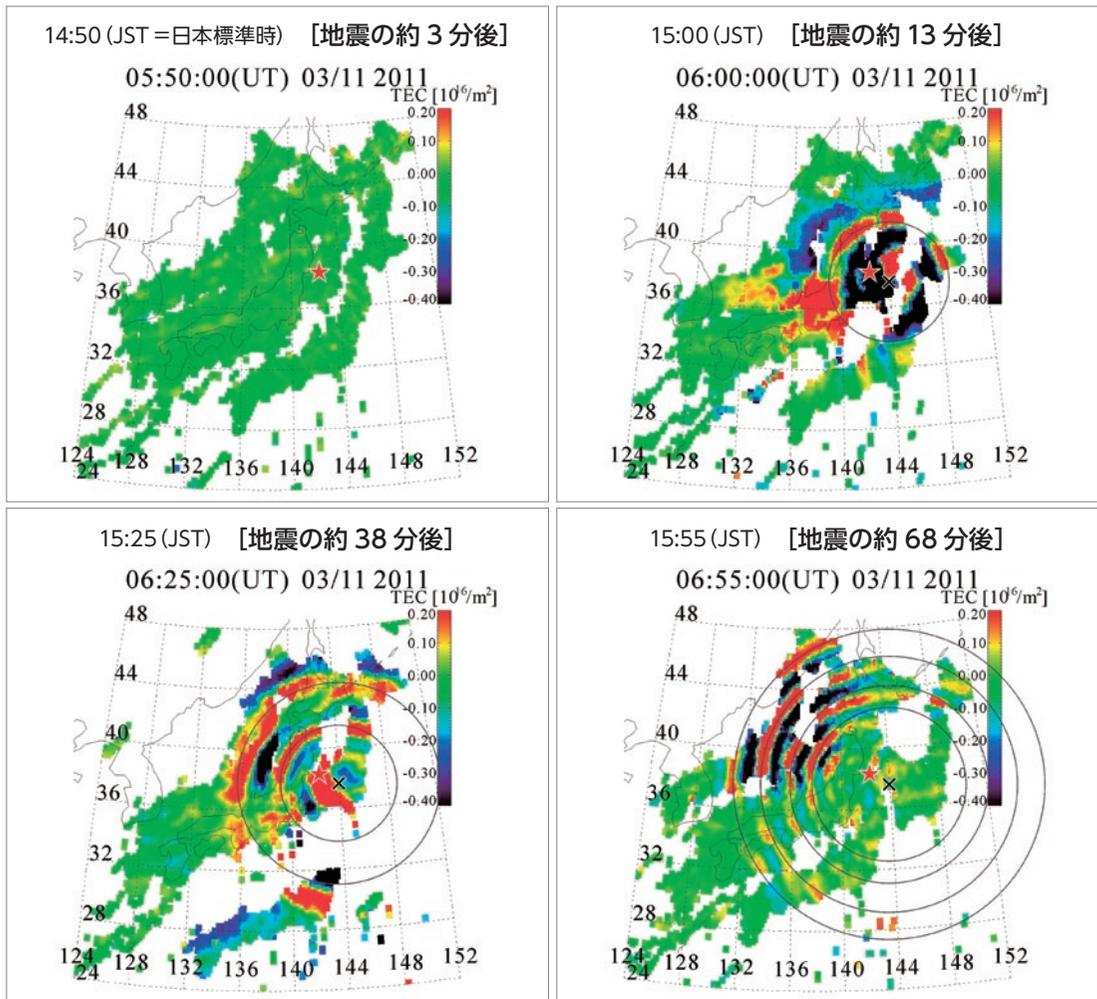
図3 GEONETを利用して算出されたTEC変動
