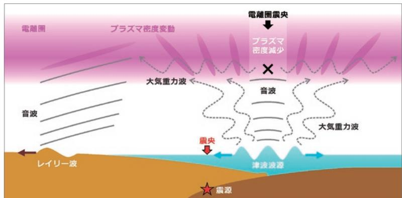
図5 地震後の大気波動と電離圏変動の発生メカニズム
