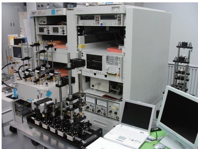
図3 110GHzまでの電力計較正システム
