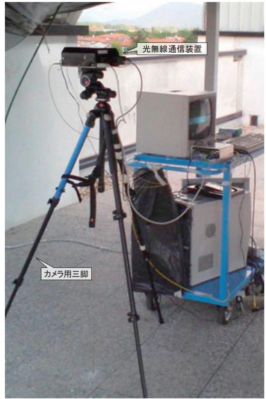
図4 サンタナ大学通信研究所の屋上に設置した光無線通信装置
