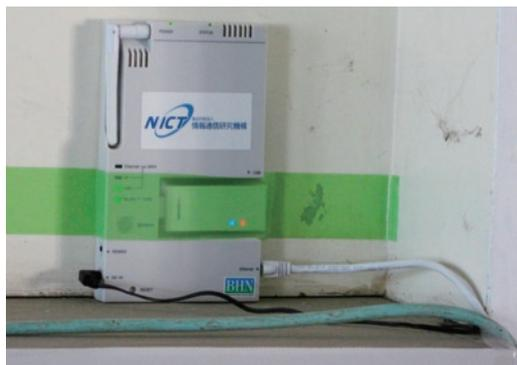
図2 インターネット接続に用いたコグニティブ無線ルータ
