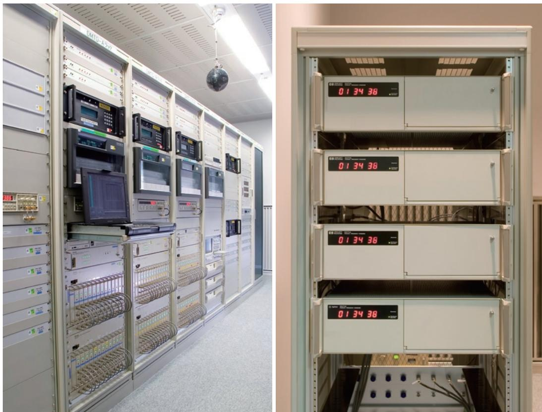
図1 日本標準時システム(左)と日本標準時生成に使われるセシウム原子時計(右)
