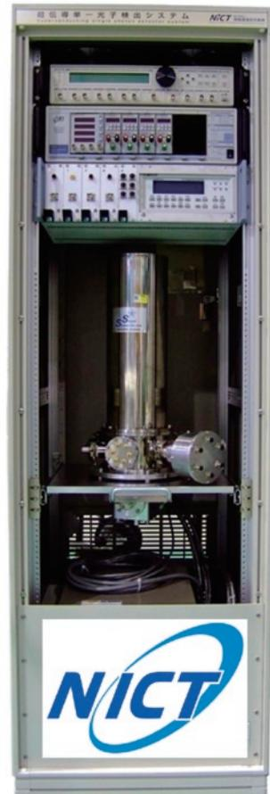
図3 マルチチャンネルSNSPDシステム
