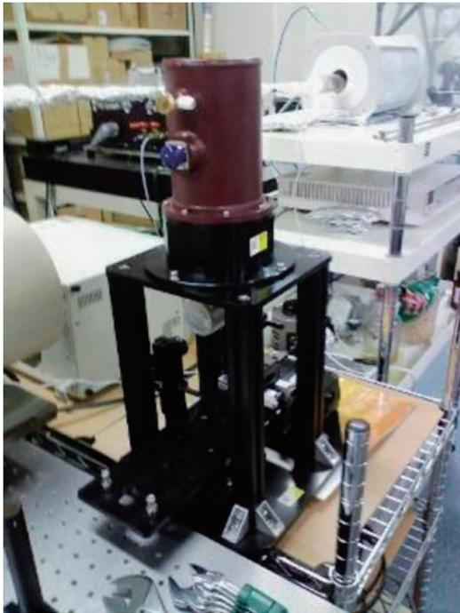
図2 液体窒素冷却THz-QCLシステム
