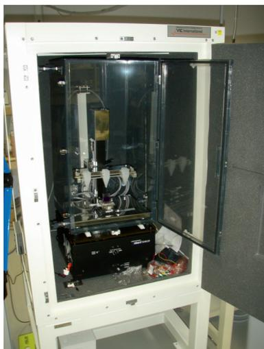
図 6 防音防振ボックス内に設置されたディップコーティング装置
