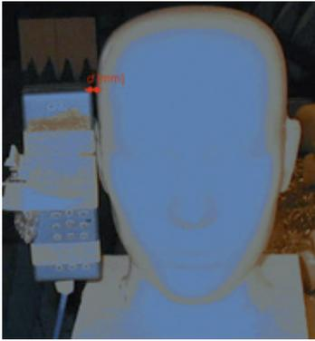
図 18 ファントムに携帯端末を取付けた様子
