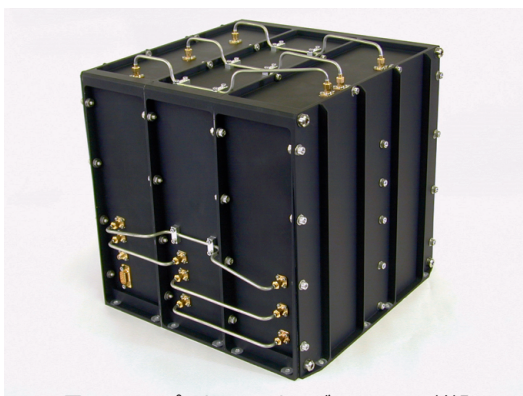
図 2 TCE プロトフライトモデル (PFM) の外観
