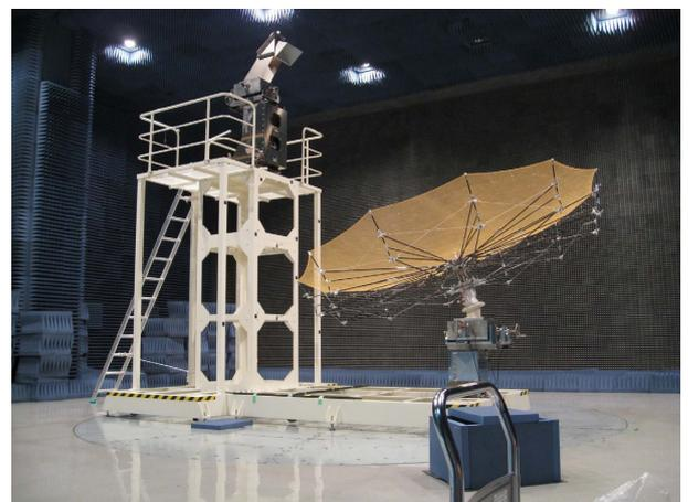
図 21 S 帯ホーンを用いたアンテナ構成外観
