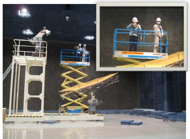
図5 鏡面形状計測の様子
