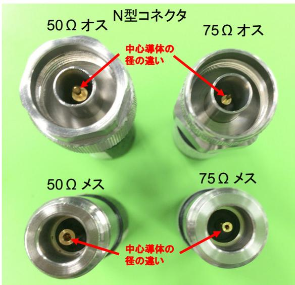
図7 N型同軸コネクタの形状
