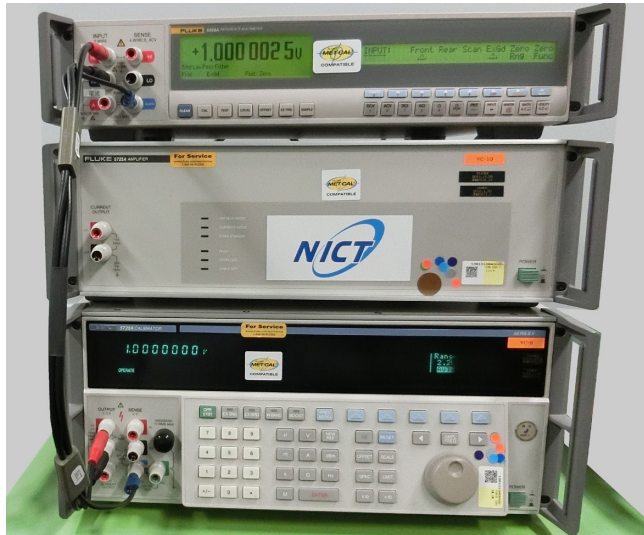
図2 標準電圧電流発生器の校正 (上段) マルチメータ: Fluke 8508A、(中段) 増幅器: Fluke 5725A (下段) 標準電圧電流発生器: FLUKE 5720A
