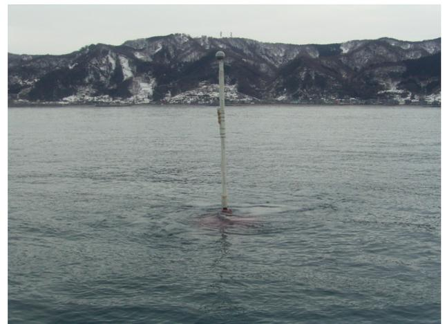
図4 1 NM 固定物標(スパーブイ方式)
