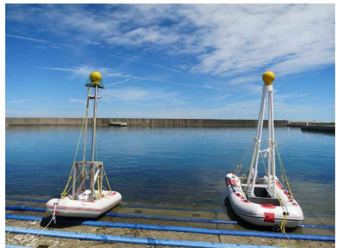
図5 1 NM 固定用物標(左側)と移動物標(右側)
