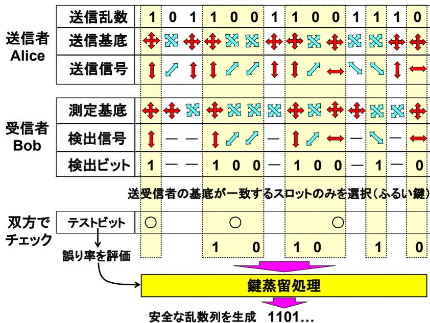
図 1 偏光を用いた場合の BB84 プロトコルの概要 (送受信者間でのビット情報や基底情報の対応表)
