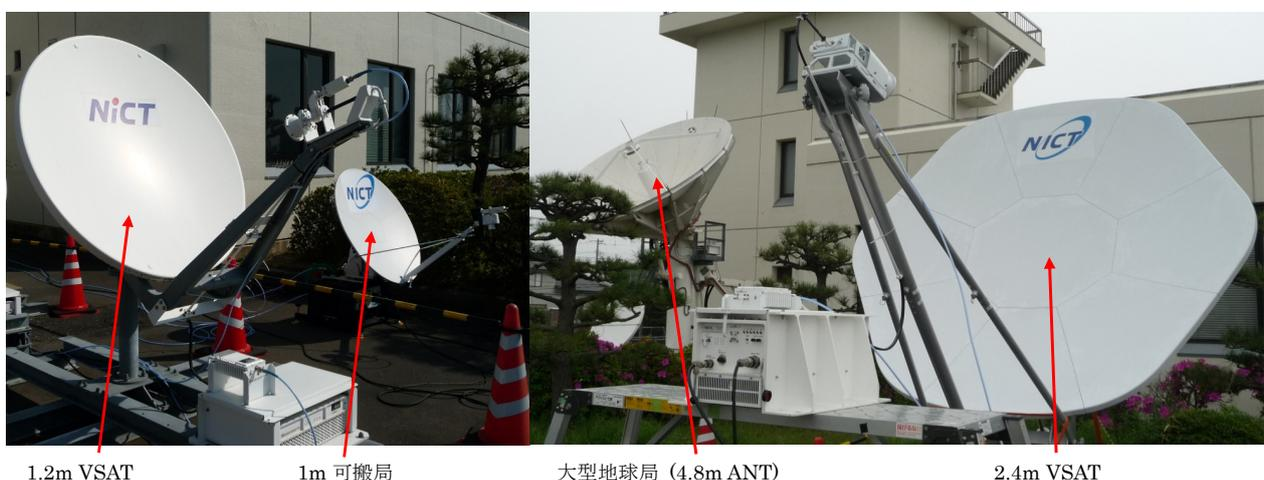
図 1 再生交換中継降雨減衰補償実験の屋外装置
