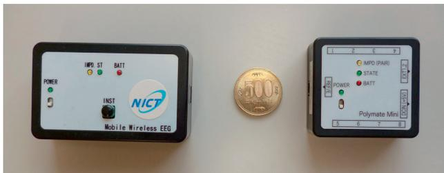
図2 開発した小型の脳波計の計測部(左)とこれを基にして製品化された脳波計の計測部(右)。計測部に電極をつなぎ、その電極を頭に付着させる。信号は Bluetooth より計測 PC に送られる。
