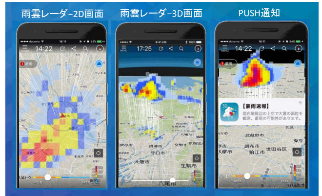
図6 スマホアプリ「3D雨雲ウォッチ」によるフェーズドアレイ気象レーダーの観測データ表示。(左)真上から視点による水平降雨分布、(中)3次元降雨分布、(右)PUSH通知の例(エムティーアイ提供)。
