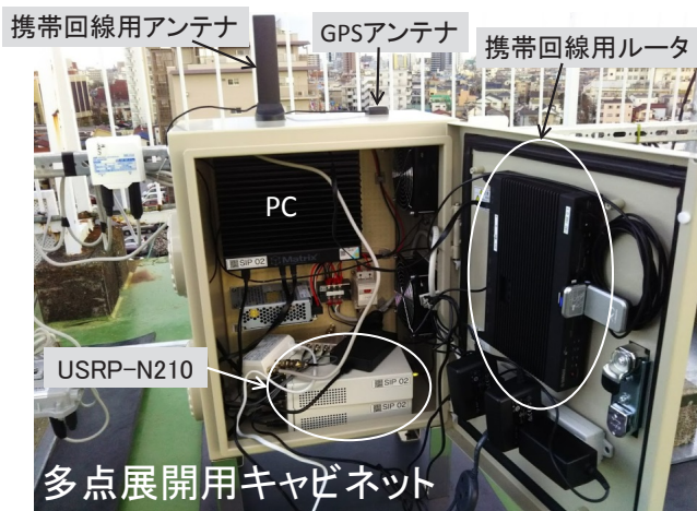
図 2 ソフトウェア無線の技術で開発した観測装置
