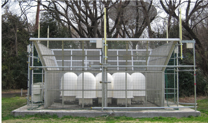
図1 次世代 WPR の開発プラットフォームとして使用されている既設 WPR (LQ-13) の外観。黄色いFRPパイプに取り付けられた5本のコリニアアンテナはクラッタ抑圧用サブアレイである。
