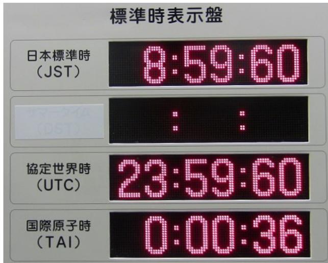
図7 2017年1月1日の8時59分60秒(JST)を示す標準時表示盤
