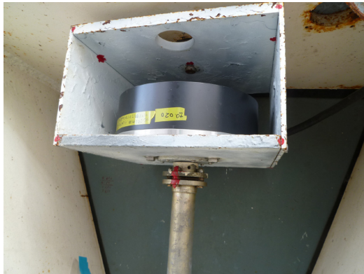
図4 AZ角度エンコーダと基準軸の接続支柱(左)及びAZ基準軸の模式図(右)
