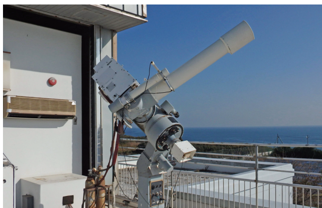
図5 高精細H \alpha 望遠鏡
