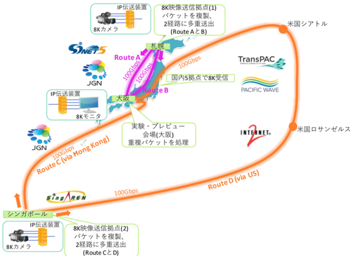
図4 シンガポール-日本間 8K 多重化ライブ配信実証実験
