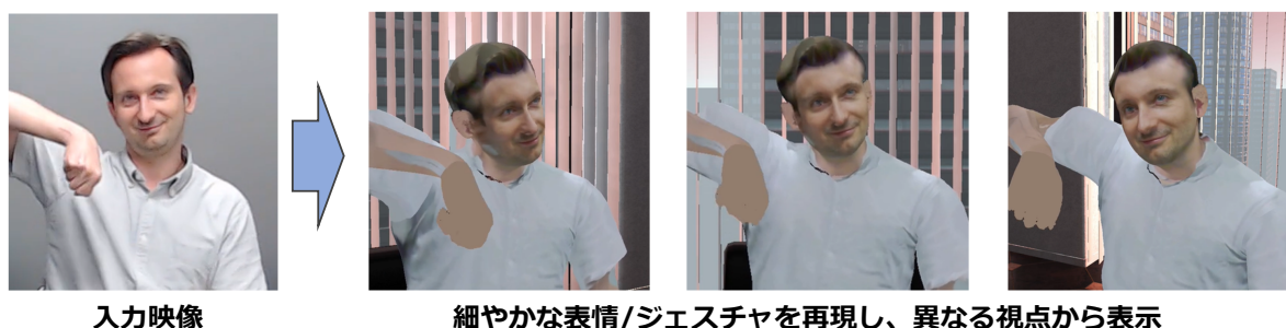
図 3 REXR で構築・再現された本人のリアルで表情豊かな 3D アバター
