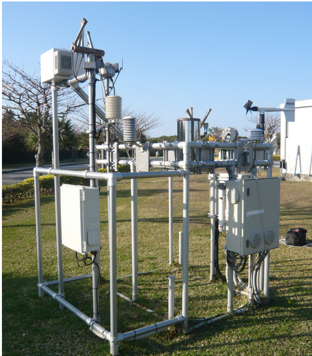
図 7 環境データ情報収集装置（沖縄）の外観
