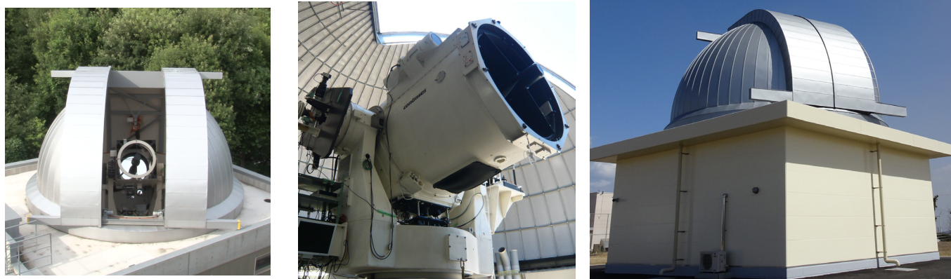
図5 NICT 本部 (小金井市) の口径 1 m (左) と口径 1.5 m (中央) 及び鹿島宇宙技術センター (鹿嶋市) の口径 2.05 m (右) の光アンテナ
