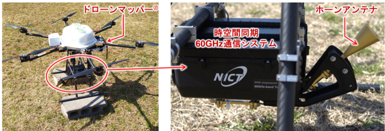
図 1 ドローン間すれ違い通信実験で使ったドローンの外観
