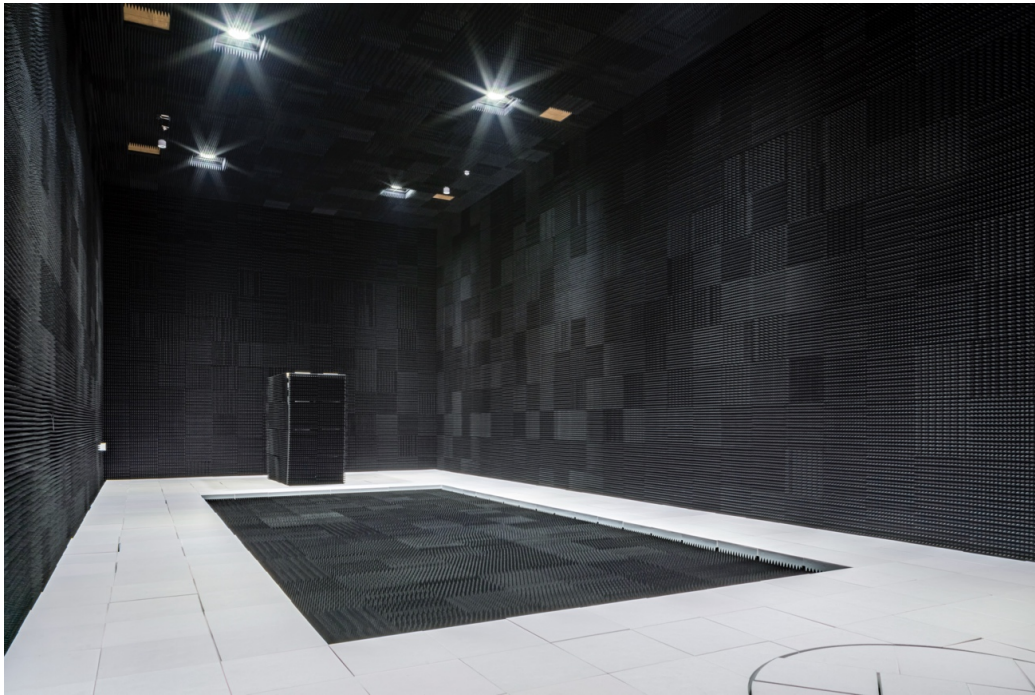
図3 電波暗室内部(左奥が上昇させた状態のリフター、右手前の半円部分がターンテーブルの一部である。)
