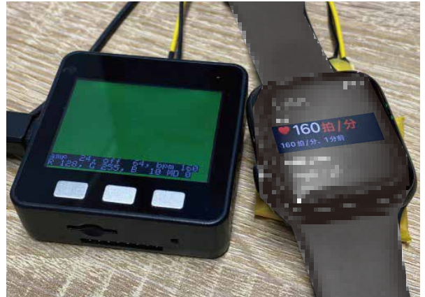
図7 評価のためのセットアップ (左: M5Stack、右: 図6の上に攻撃対象を載せた様子)
