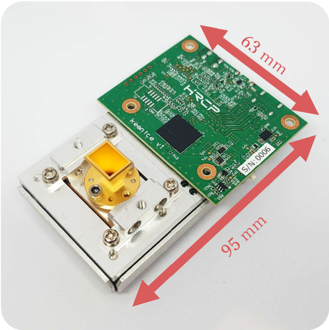
図 8 TJX-SoC を活用した IEEE802.15.3e 準拠無線通信モジュールの外観
