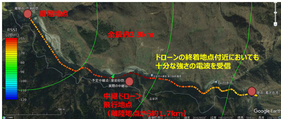
図3 試験場所におけるドローンの飛行軌跡及び電波の受信強度
