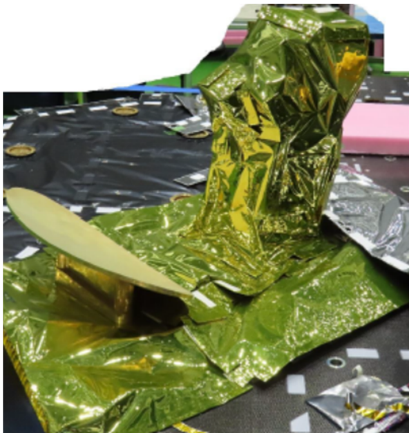
図 9 アンテナデッキ (地球指向面) への CCS-ANT 搭載状態
