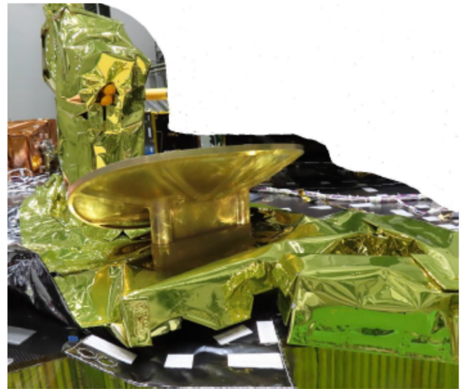
図 9 アンテナデッキ (地球指向面) への CCS-ANT 搭載状態
