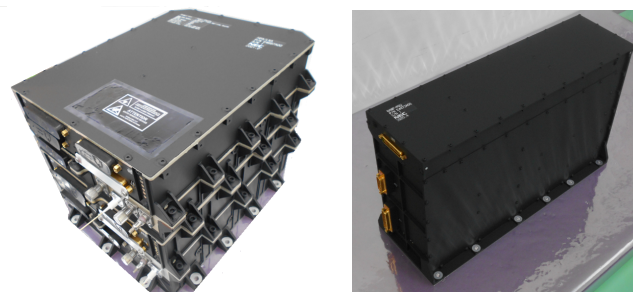
図4 OAMP (光増幅部) 外観 (左：本体、右：PSU (電源ユニット))
