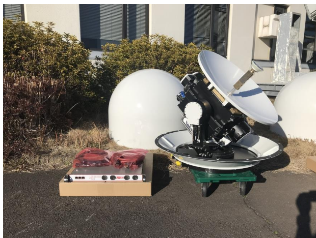
図 6 小型移動体地球局外観
