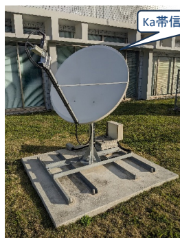
Ka帯信号強度測定部及び環境センサー部(沖縄) データ収集室内装置(沖縄)
