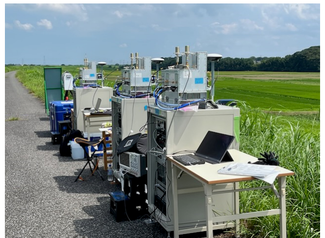
図8 能動型レーダー校正器 (ARC) を3台並べた様子 (動作確認時。実際には約400 m間隔で配置する。)
