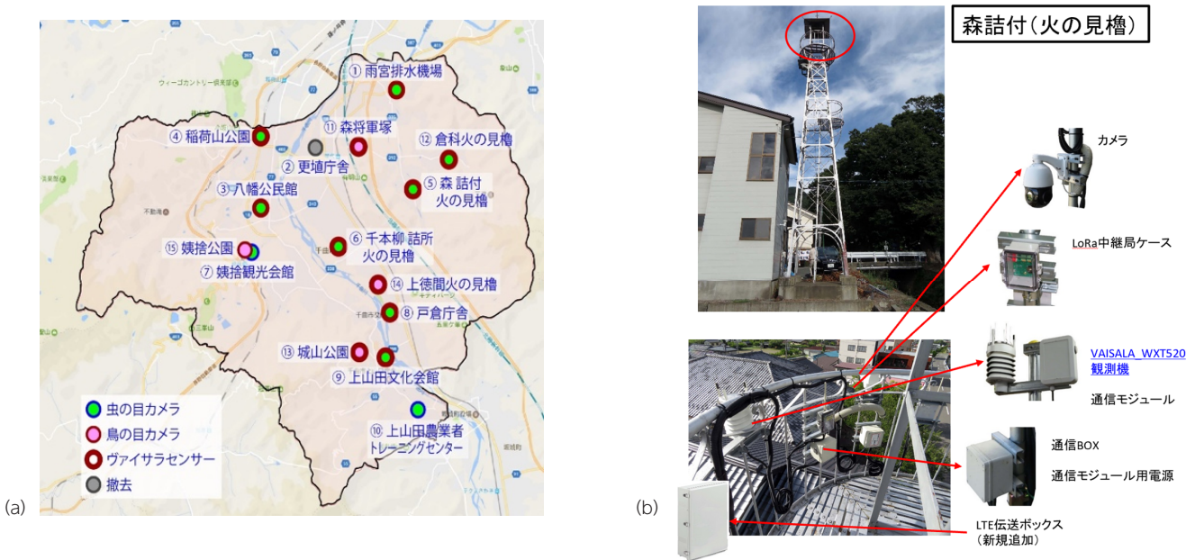
図1 (a)千曲市あんずネットワーク、(b)映像IoTシステム(例)
