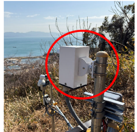
図15 (a) 富山県下新川海岸 (田中) 設置、(b) 愛媛県松山市 (興居島) 設置の電力自立型虫の目映像伝送システム
