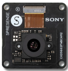
図13 (a) SONY社製マイコンボードSpresense (写真はSpresense用カメラモジュール)、(b) Spresenseをベースとした電力自立型虫の目映像伝送システム
