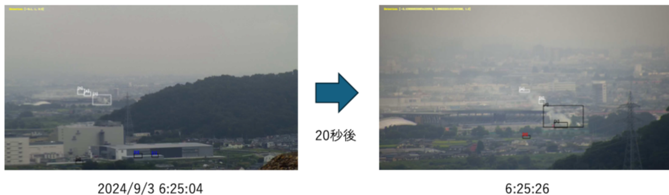
図5 煙自動検出処理結果(焼捨公園カメラ)
