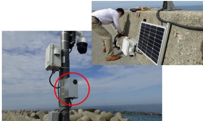
図15 (a) 富山県下新川海岸 (田中) 設置、(b) 愛媛県松山市 (興居島) 設置の電力自立型虫の目映像伝送システム
