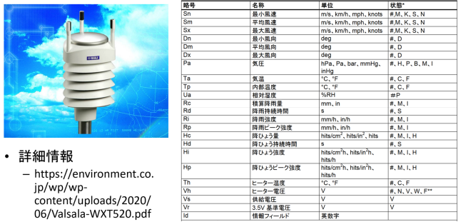
図2 気象ステーション(気象センサー)
