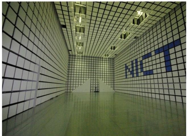
**Fig. 4** Semi-Anechoic Chamber (SAC)
