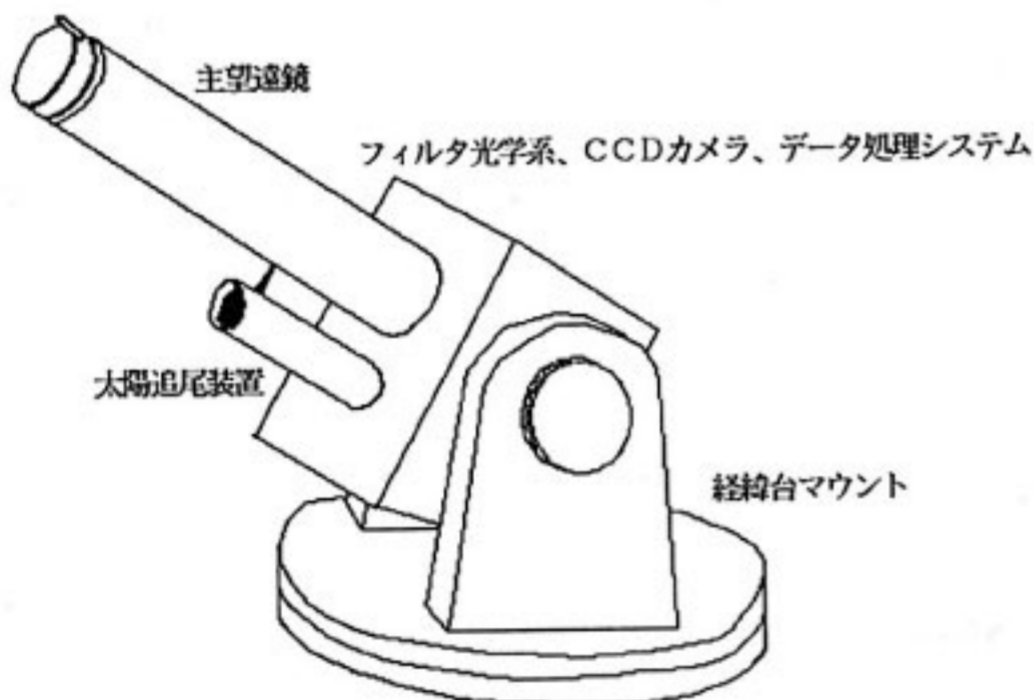
第8図 成層圏プラットフォーム用太陽監視装置概念図
