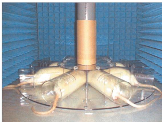
図5 ラット脳局所曝露装置 共振長モノポールアンテナ 周波数 1500 MHz
