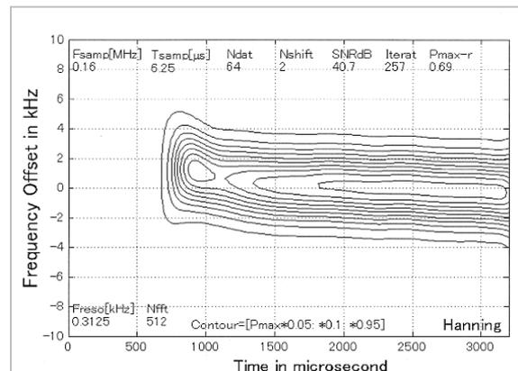
図16 車載型無線機のスペクトログラム、SNR $\approx$ 40dB、 $N_{dat}$  = 64、 $N_f$  = 512
