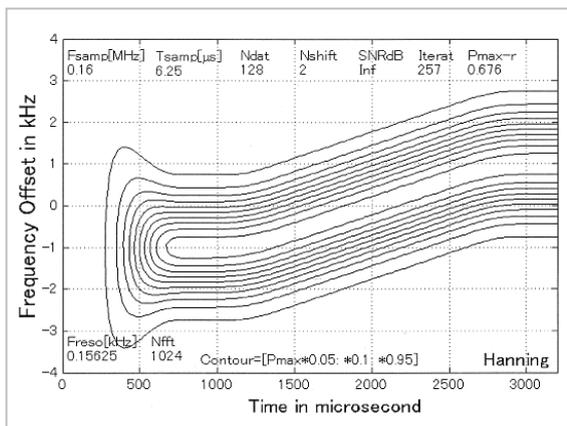
図10 ±1 kHzチャープ信号のスペクトログラム、 $N_{dat}=128$ 、 $N_f=1024$
