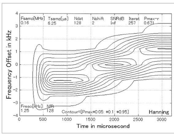
図9 ±1 kHzチャープ信号のスペクトログラム、 $N_{dat}=N_f=128$
