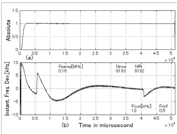
図13 ハンディ型無線機の(a)絶対値と(b)瞬時周波数、SNR $\approx$ 60dB、 $F_{cut}$  = 10 kHz
