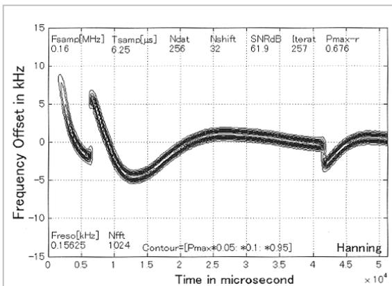
図14 ハンディ型無線機のスペクトログラム、SNR $\approx$ 60dB、 $N_{dat}$  = 256、 $N_f$  = 1024
