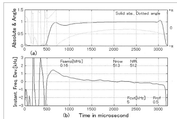
図15 車載型無線機の(a)絶対値と(b)瞬時周波数、SNR $\approx$ 40dB、 $F_{cut}$  = 5 kHz
