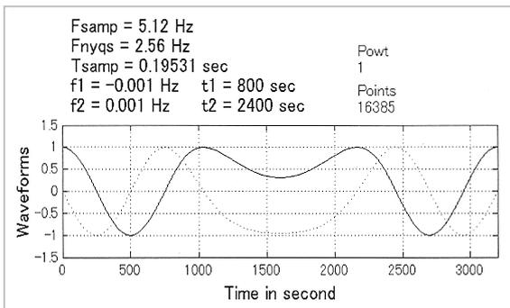
図7 チャープ信号(例2)の実部:実線と虚部:点線
