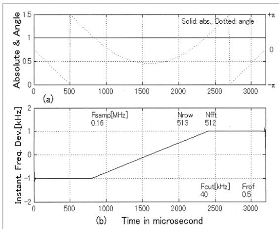
図8 ±1 kHzチャープ信号の(a)絶対値:実線と位相:点線、及び(b)瞬時周波数
