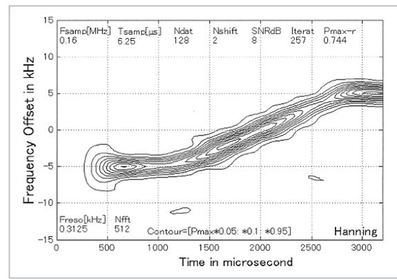
図12 ±5 kHzチャープ信号のスペクトログラム、SNR=8dB、 $N_{dat}=128$ 、 $N_f=512$
