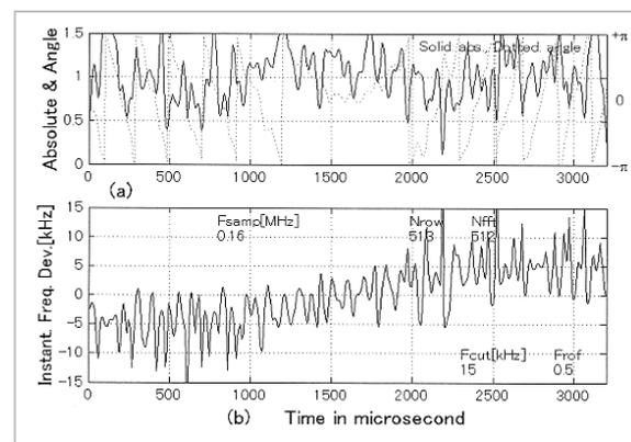
図11 ±5 kHzチャープ信号の(a)絶対値・位相と(b)瞬時周波数、SNR = 8dB、 $F_{cut}=15\text{ kHz}$
