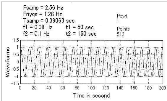
図6 チャープ信号(例1)の実部:実線と虚部:点線
